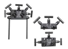
Трех (VS 300) и пятивентильные (VS 500, VS 501) клапанные блоки предназначены для использования в комплекте с датчиками перепада давлений, для обеспечения перекрытия импульсных линий и уравнивания давлений в обеих камерах датчика давления при установке нулевого значения. Кроме того пятивентильные клапанные блоки оснащены дренажными клапанами.
