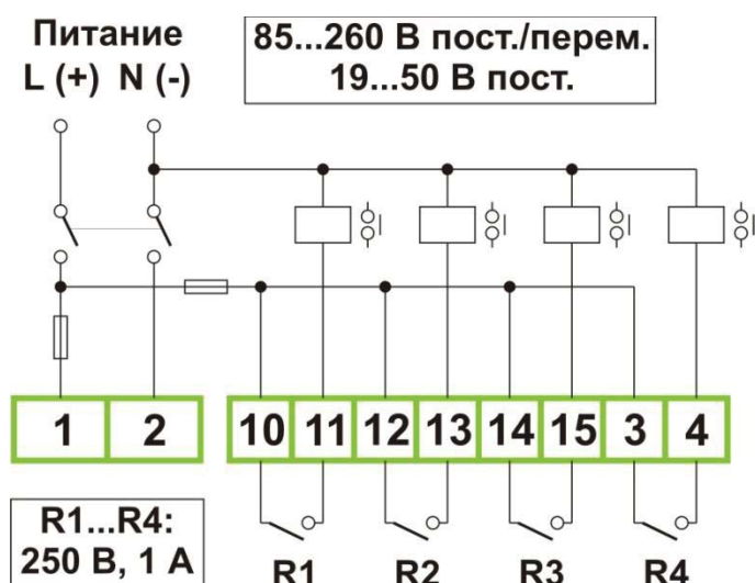
Рисунок 2.12. Пример включения реле выхода (тип – “сухой контакт”).
