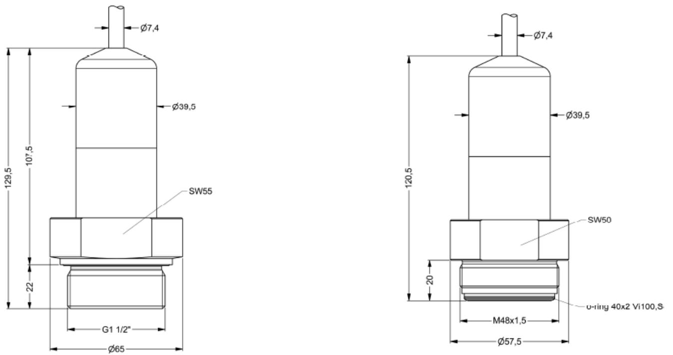
**Рисунок Б.2.** Габаритные размеры датчика ЛМК 458 врезного (слева) и фланцевого (справа) исполнений.
