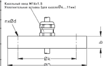
**Рисунок Б.3.** Размеры монтажных фланцев для датчика LMK 458 (не входят в комплект поставки).
