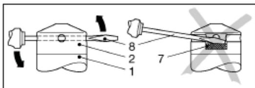
**Рисунок 1.** Снятие защитной крышки (заглушки) погружного датчика.
