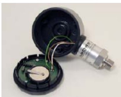
Рисунок Б.2. Место установки элементов питания.
