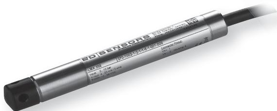
Погружной зонд LMK 306 сверхмалого диаметра (17 мм) с керамическим сенсором, предназначен для непрерывного измерения уровня жидкостей, неагрессивных к нержавеющей стали.
